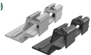
1. Das erste Profildende in den Außenverbinder einlegen und mit Torx 40 mit einem Anzugsmoment von 6 Nm die entsprechende Profilklemme festziehen.
